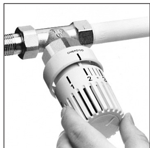
Рис. 9: Слегка нажимая на маховик, повернуть его на цифру „2“. Снова снять маховик. (Теперь метка юстировки на чувствительном элементе скручена вправо.)
