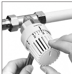
Рис. 12: Снять маховик при помощи специального инструмента (арт. № 198 91 00) или подходящего штифта, вставив его в демонтажное отверстие на нижней стороне термостата. Повернув маховик вправо до положения отключения его можно легко снять.
