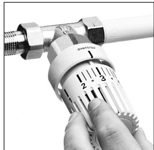
Рис. 8: Надеть маховик, чтобы цифра „3“ была напротив указателя настройки.
